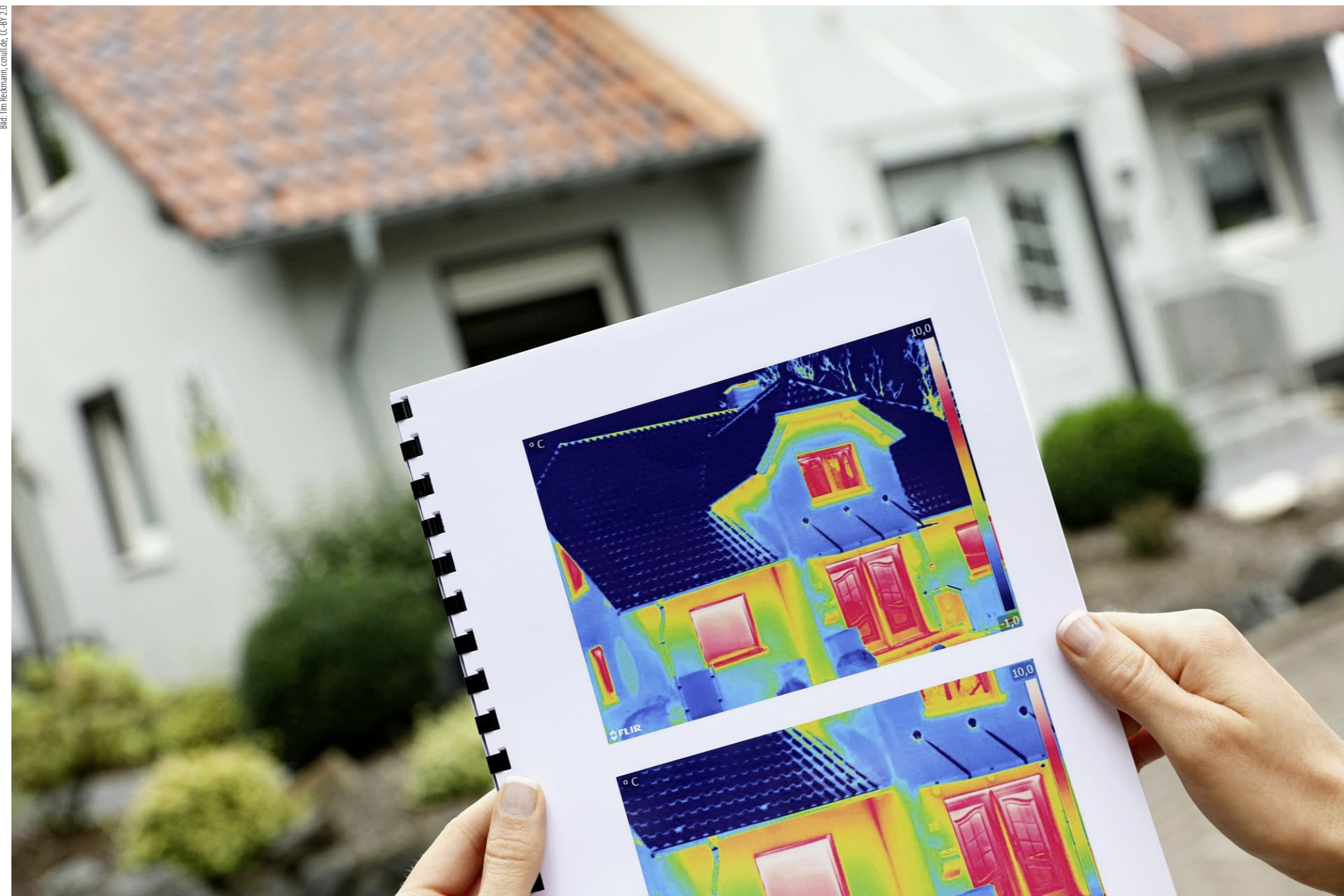
Thermografie eines Gebäudes: So wünschbar eine Gesamtsanierung unter Einbezug der Gebäudehülle ist, so lässt sich auch schon mit der Isolierung der Kellerdecke ein wirksamer Effekt erzielen.
