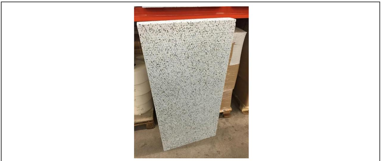
Bei dieser Verwertungsoption kann das HBCD nicht ausgeschleust werden. Somit können nur HBCD-freie EPS – Schaumstoffplatten (Verschnitte) verwertet werden. Platten aus dem Rückbau können nicht aufbereitet werden.
