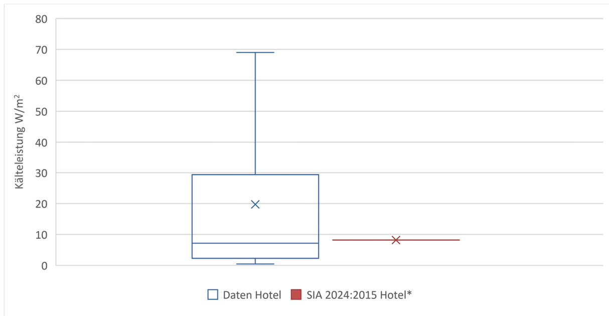
Abbildung 8 Auswertung der Daten zur installierten Kälteleistung Hotel (n=47) (*Annahme dieses Projektes, siehe auch Tabelle 4)
