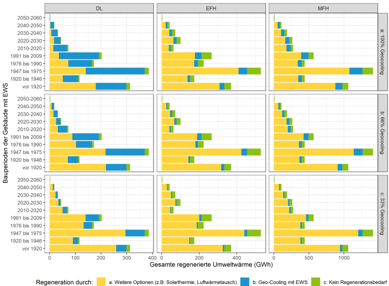
Abbildung 20: (Grenzwert:3) Summe der jährlich von EWS bezogenen Wärme und Regenerationsoptionen. Die Wärme stammt entweder aus natürlich-nachfließender Umweltwärme (grün), d.h. ohne Regenerationsbedarf oder aus den Regenerationsoptionen (blau und gelb).
