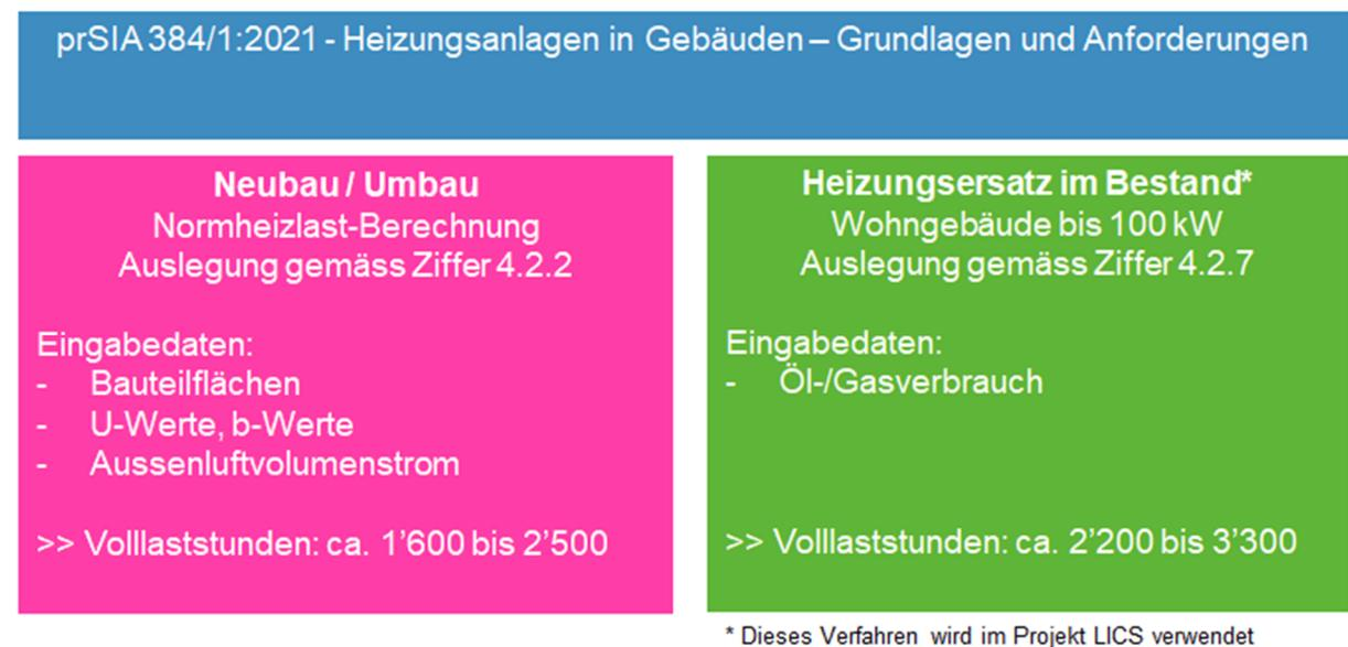
Abbildung 2 Verfahren zur Abschätzung des Wärmeleistungsbedarfs gemäss prSIA 384/1
