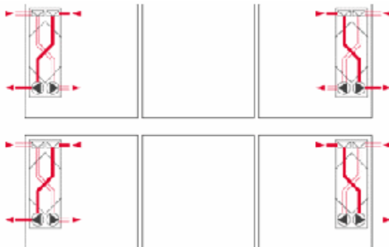
Figur 51: Einzelraum-Komfortlüftung (Quelle: MINERGIE)
